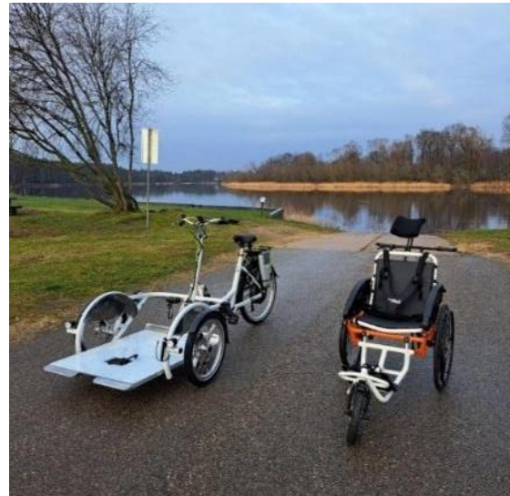
Joonis 1. Van Raam Velo Plus ratastooliveoks mõeldud platvormiga jalgratas (vasakul) ja Joëlette Finisher maastikuratastool (paremal)
